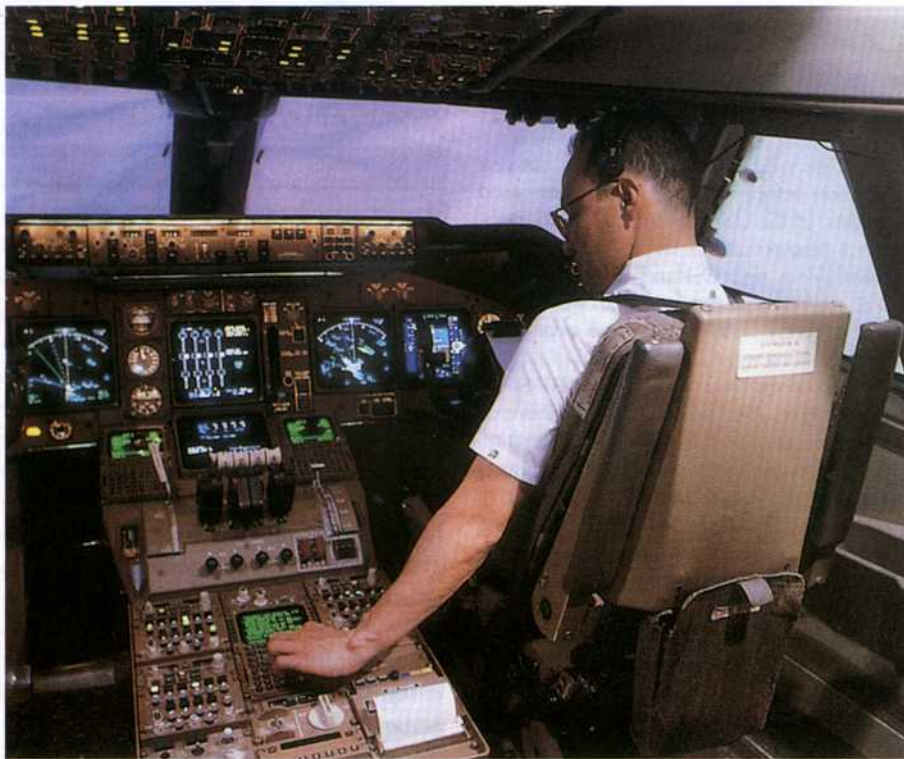
Piloto intercambiando mensajes CPDLC a bordo de un Boeing 747-400 en el Pacífico Sur. Pilot exchanging CPDLC messages on board a Boeing 747-400 in the South Pacific.
