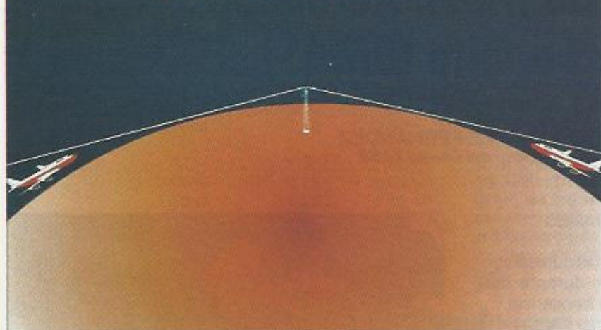
Fig. 3. La curvatura de la tierra limita el alcance del VHF al quedar las aeronaves por debajo del horizonte y no poder comunicar con ellas.
